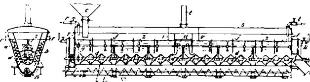
einzelnen Kammern durch umlaufende Flügel  $z$  einer durchgehenden Welle in kreisender Bewegung gehalten wird.
