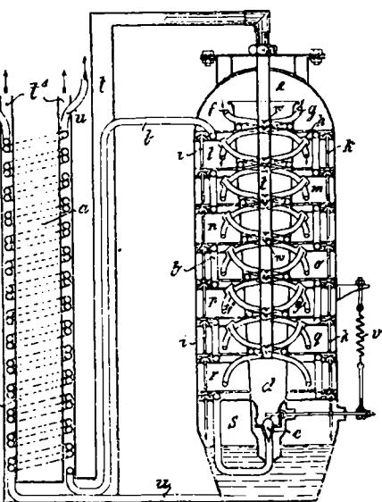
Wasserdampfs oder eines Gemisches von Wasserdampf mit anderen Gasen bei der für die Umsetzung des im Ausgangsmaterial enthaltenen Stickstoffes in Ammoniak günstigen Temperatur, dad. gek., daß die Temperatur auf elektrischem Wege durch innere Erhitzung (Widerstandsbeheizung) des Ausgangsmaterials erzeugt wird. —
