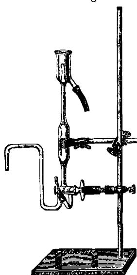
**Henri Vigreux.** Eingeschliffener Apparat für die Vakuumdestillation von Körpern, welche Kork angreifen. (Ann. Chim. anal. appl. 19, 220—221 [1914].) Alle Verbindungsstellen des mit Destillationsaufsatz und Vorlage versehenen Destillierkolbens sind eingeschliffen. Zu beziehen von Leune, Paris, rue du Cardinal-Lemoine 28<sup>bis</sup>.
